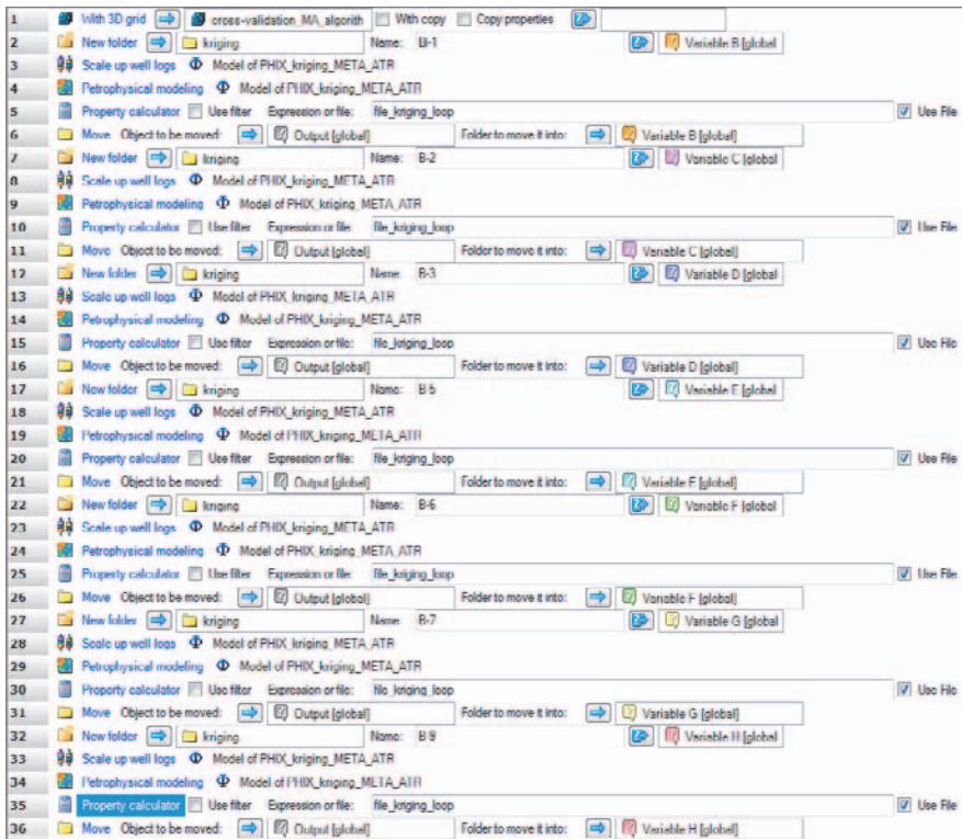
Rys. 5.3.1. Przykład pętli obliczeniowej zaprojektowanej przez autora dla algorytmów deterministycznych (kriging); Bi-1, B-2, ..., B-9 – otwory eliminowane kolejno z zestawu danych; Model of PHIX_kriging_META_ATR – poddawany walidacji model porowatości
